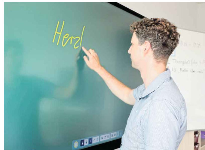
Kreidetafeln waren einmal. In den Klassenräumen der Grundschule Stukenbrock hängen nun digitale Tafeln. Sie funktionieren wie ein großes Tablet, Schüler und Lehrer können darauf mit Stiften oder auch mit dem Finger schreiben, wie Benjamin Dreier demonstriert.
